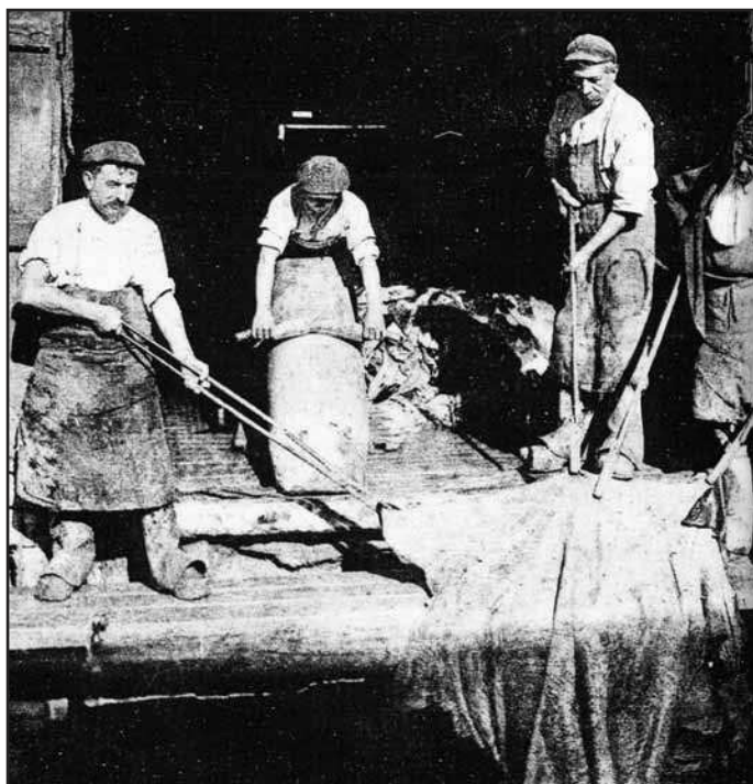
Placée sur un chevalet, une peau est assouplie à l'aide d'une lame sans tranchant.
